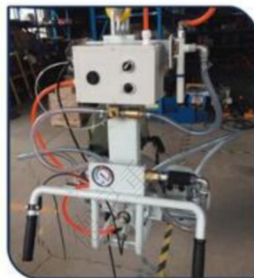
高压开关柜门板真空吸盘
