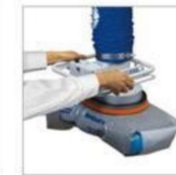
袋装工件吸盘 用于搬运纸袋和塑料袋、生橡胶块及包装膜
